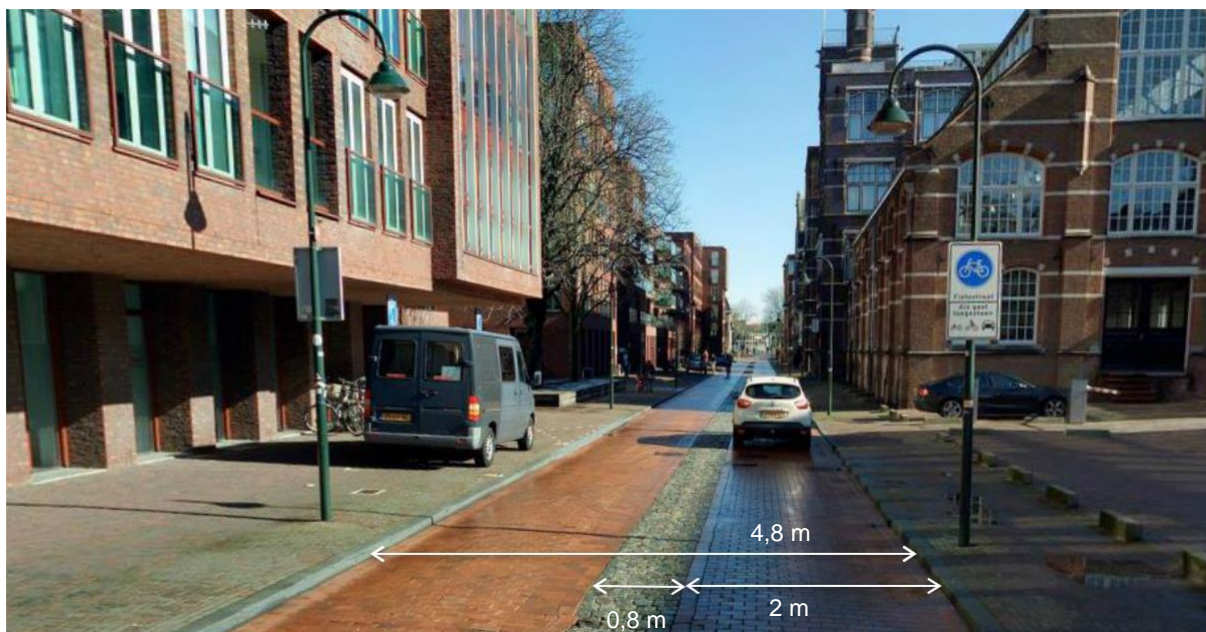
Figuur 4: Hoewel in deze straat veel ontwerpelementen zijn toegepast, adviseren we om hier toch niet het bord Fietsstraat (L51) te plaatsen omdat het rode asfalt ontbreekt. Het type bebording dat hier gebruikt is, wordt overigens sowieso afgeraden (zie paragraaf 4.4).
