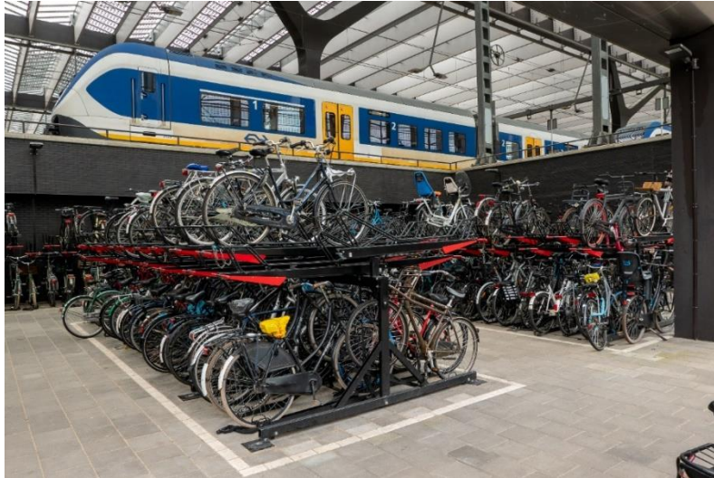
Figuur 6: Maaiveldstalling met etagerekken. Een groot aantal fietsen per m 2 , met op het bovenste rek enkele fietsen met kinderzitjes (deze passen veelal niet in het onderste rek).
