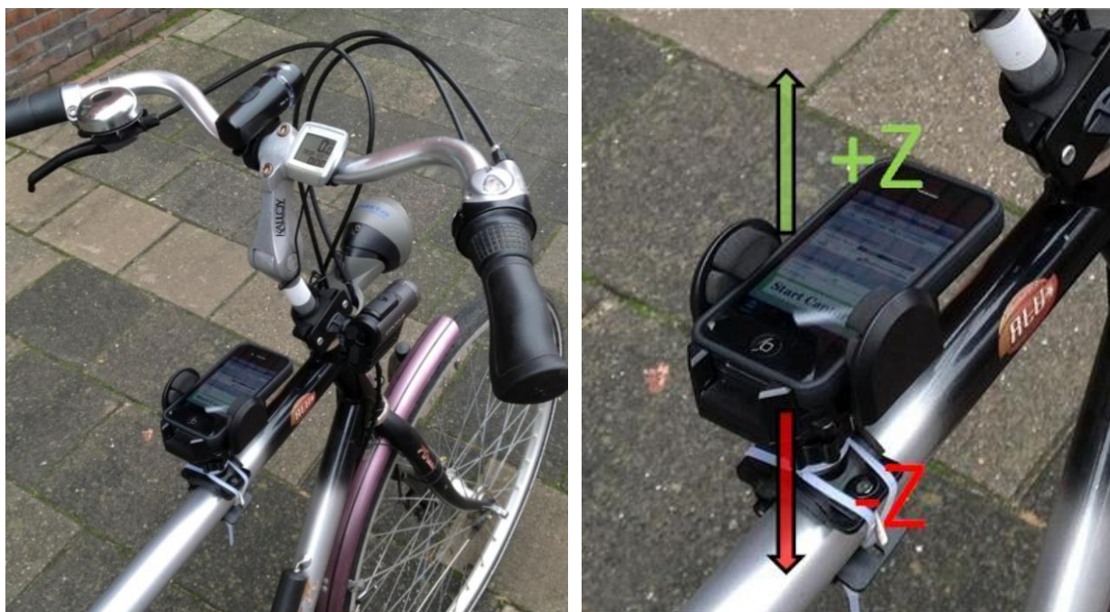
Figuur 25. Op de 'stang' bevindt zich de iPhone, aan de stuurpen de Contour+2 camera, op het stuur een LED fietslamp (links) en de fietscomputer (rechts).
