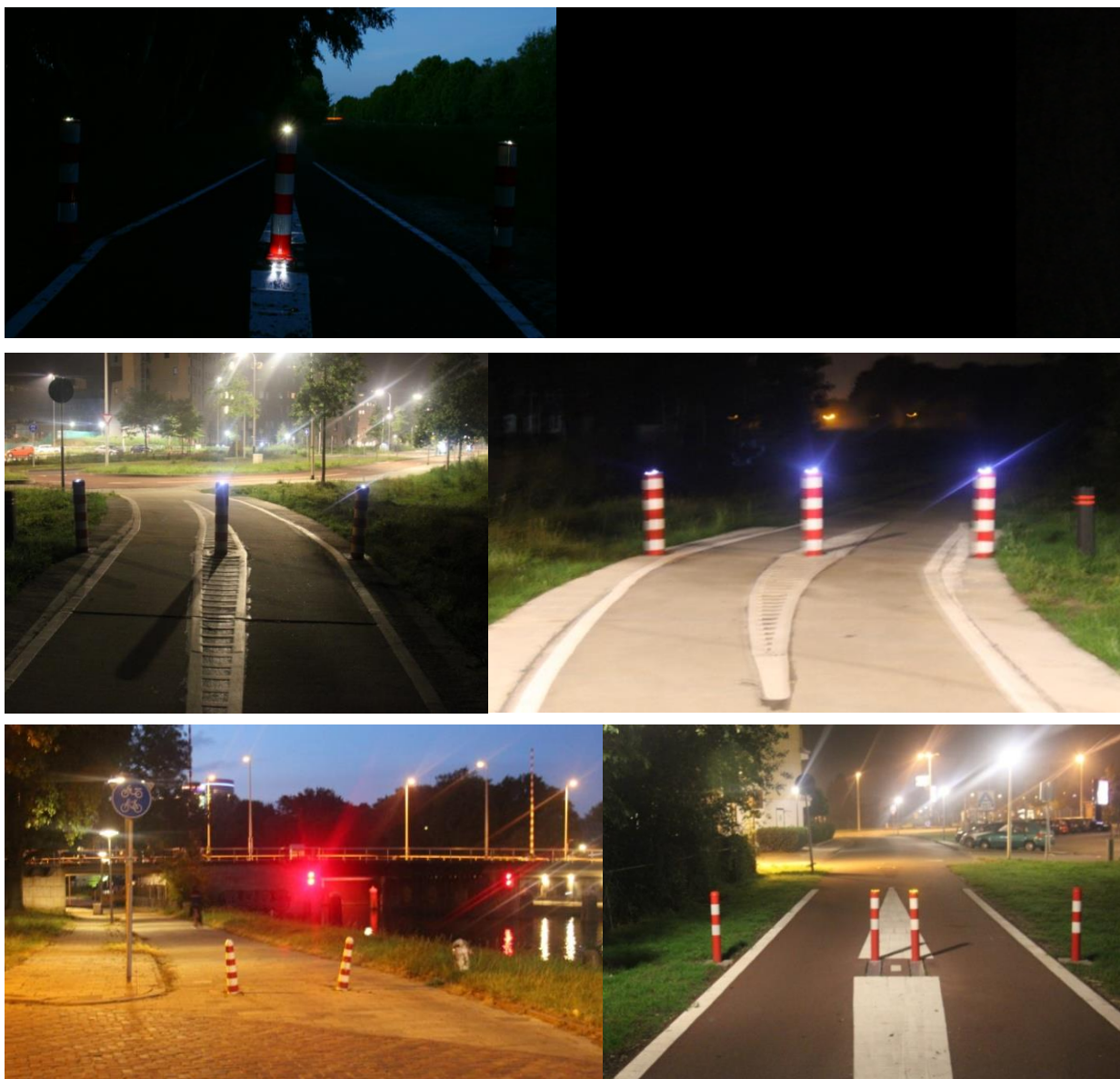
Figuur 22. Impressie zichtbaarheid palen bij duisternis. Boven: Hardenberg (links) met LED's die o.a. de paal aanschijnen en Bunnik (rechts) zonder enige vorm van verlichting. Midden: Zwolle met de blik naar het kruispunt (links, verstorend effect van openbare verlichting op de achtergrond) en Zwolle met de rug naar het kruispunt (rechts). Onder: Controle-locatie Utrecht (links, verstorend effect bruglicht op achtergrond) en Enschede (recht, met knipperende gele LED's)
