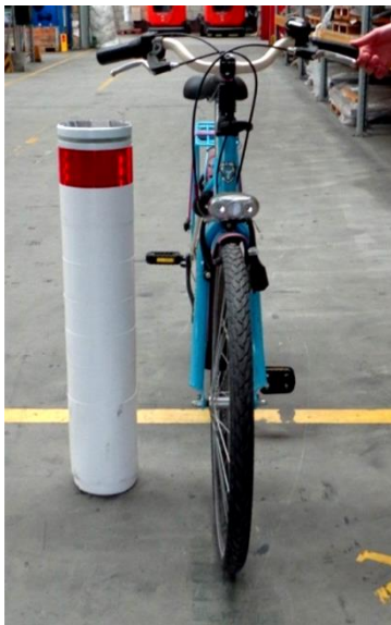
Figuur 6 de stuurhoogte van een kinderfiets vergeleken met een 85 cm hoge paal. Deze testpaal voldoet overigens nog niet aan de eis 50% rood (bron: VelopA)
