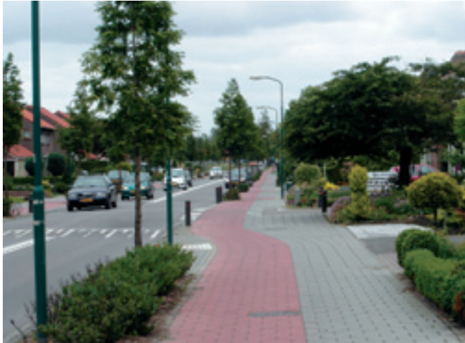
Op de drukke Buurtlaan Oost (sluiproute naar Ede) is vanwege de beperkte ruimte een gecombineerde verharding voor fietsers en voetgangers, alleen in kleur onderscheiden.
