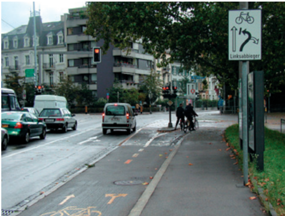
Basel. Voor de kruising gaat het aanliggende fietspad over in een fietsstrook met aparte opstelvakken voor de verschillende richtingen. Links afslaande fietsers gebruiken het rechte opstelvak om indirect links af te slaan – met een aparte groenfase.
