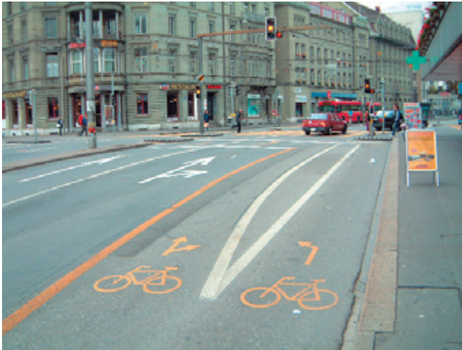
Bern. Omgeving Centraal Station, met een provisorische herinrichting van het kruispunt. Een fietsstrook met aparte opstelvakken voor de verschillende richtingen, een OFOS voor rechtdoor en rechtsaf. De ruimte voor de fietsstrook is gewonnen door de rijstroken te versmallen naar 3,00 m.
