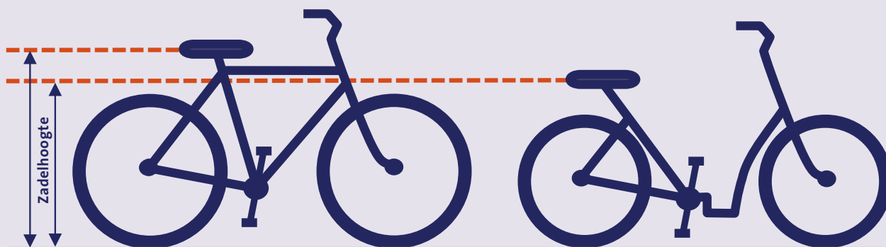
Afbeelding 10: Schets van een normale stadsfiets (links) en een model met een lagere zadelhoogte en lage instap (rechts) om op- en afstappen te vergemakkelijken. 47
