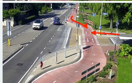
Figuur 7: Bijna-ongeluk interactietypes. Bij rode pijlen is een noodstop of spoed manoeuvre gemaakt, en bij groene pijlen is er doorgereeden zonder te wachten op de ander. De pijlen geven ook een indicatie van de positionering van de voertuigen op hetzelfde moment in tijd.
