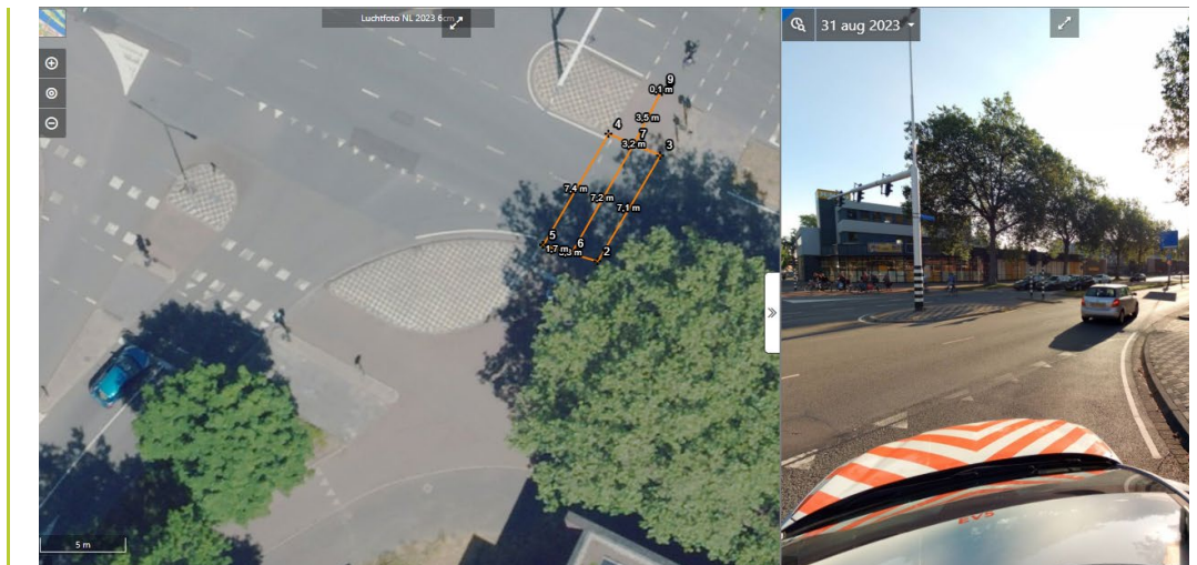
Afbeelding A.4. Oversteeklengtes ID #5-1: Eindhoven Boutenslaan and Keizer Karel V Singel & Hoogstraat (rechtsonder): L_{mid}=7,2\text{ m} , L_{max}=7,4\text{ m} , L_{min}=7,1\text{ m} .
