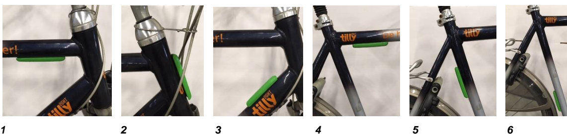
Figuur 7 Verschillende posities voor plaatsing rfid-tag op fietsframe
