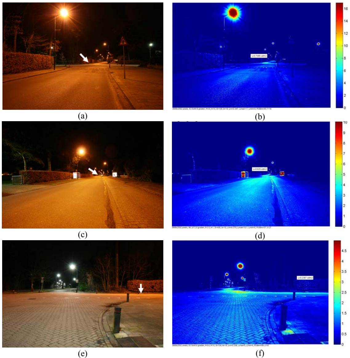
Figuur 32 Digitale foto's (linkerkolom:a,c,e) en de daaruit berekende luminantieopnamen (rechter kolom:b, d, f) voor de drie stedelijke meetsituaties. De schaalwaarden voor de luminantie zijn gegeven in \text{cd/m}^2 .
